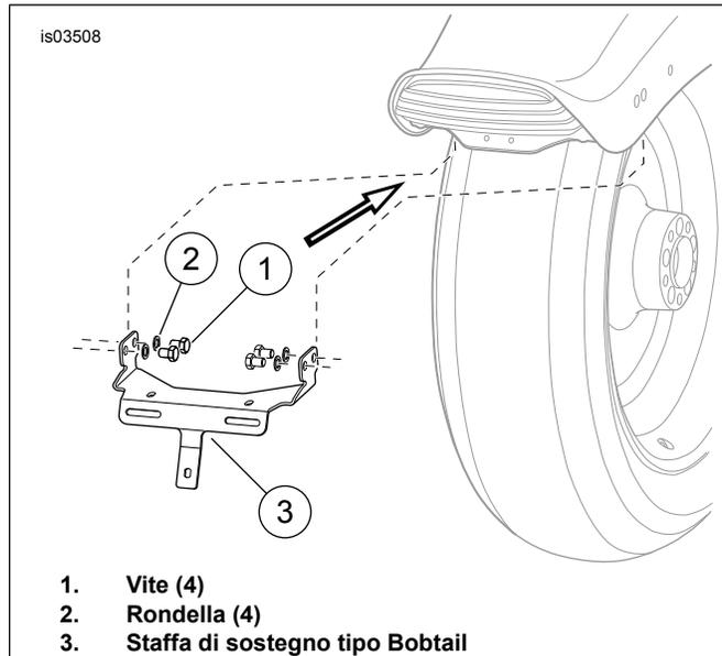
**Figura 4. Installazione della staffa di sostegno tipo Bobtail**
