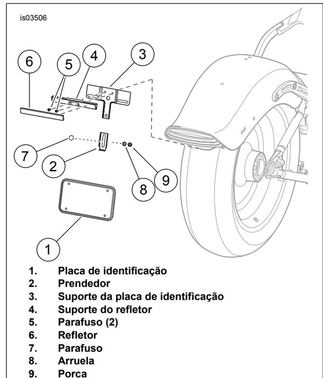
Figura 1. Remoção do refletor e do suporte da placa de identificação
