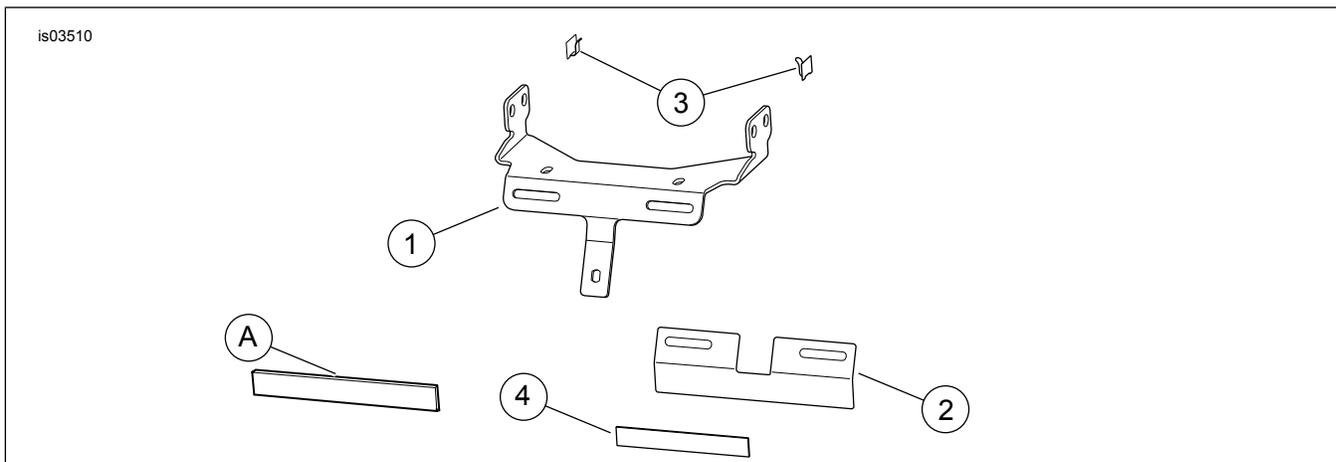
**Figura 8. Ilustración de piezas de servicio: soporte de la rejilla Bobtail**
