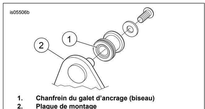
Figure 1. Installation du galet d'ancrage
