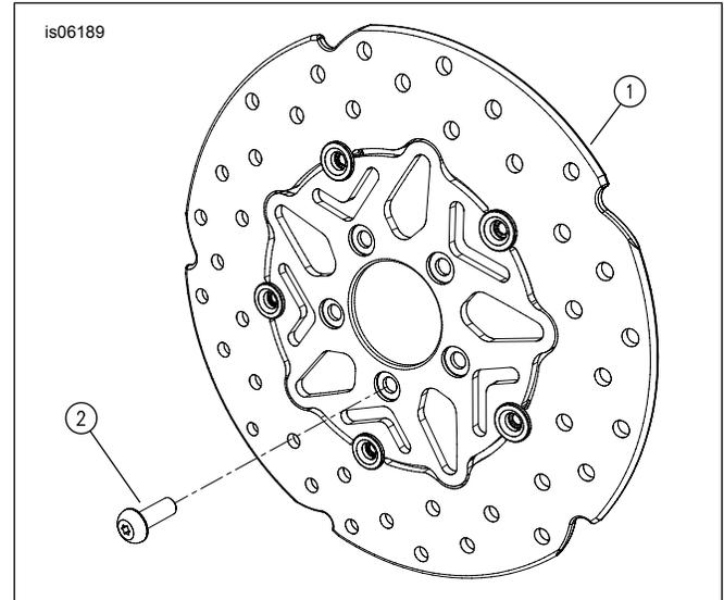
Figura 1. Peças de reposição: Kits (disco) de rotor de freio dianteiro flutuante
