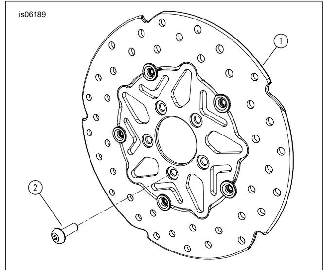
Figura 1. Piezas de servicio: Kits de rotor flotante del freno delantero (disco)
