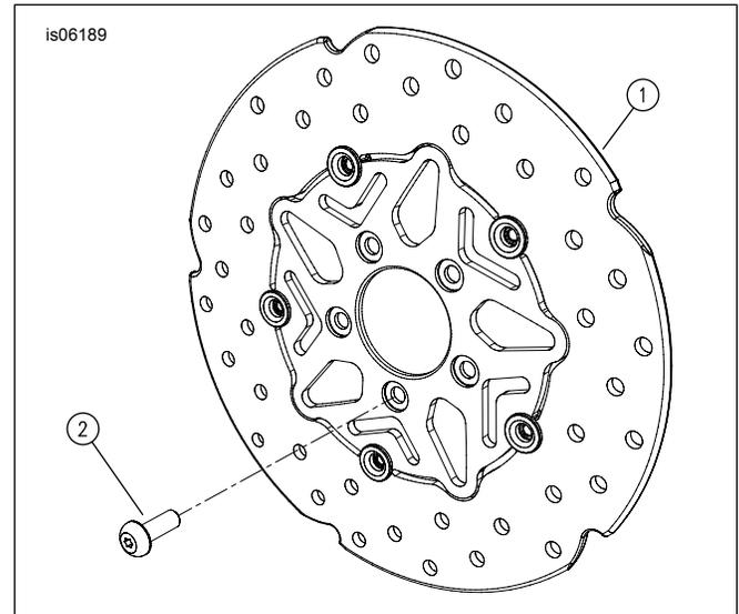
Figure 1. Pièces de rechange : Kits de rotor de frein arrière flottant (disque) (modèle Stinger illustré)
