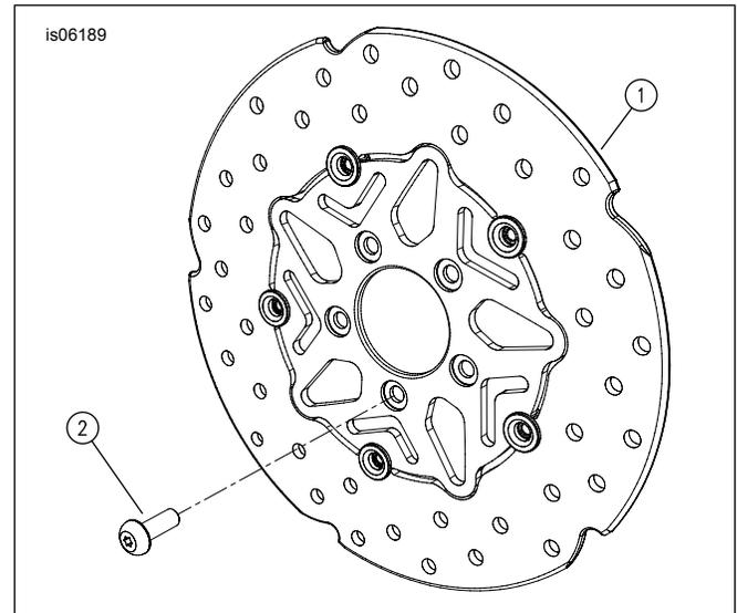
Figura 1. Peças de reposição: Kits (Disco) de Rotor de freio traseiro flutuante (Estilo Stinger mostrado)
