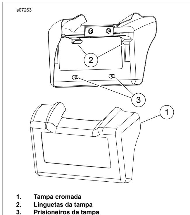
Figura 1. Tampa cromada para resfriador de óleo
