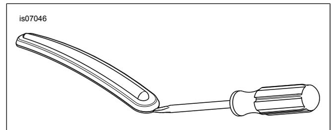
Figura 1. Remoção da faixa de acabamento do para-lama
