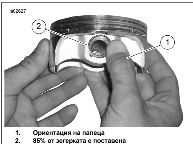
Фигура 4. Монтаж на зегерка
