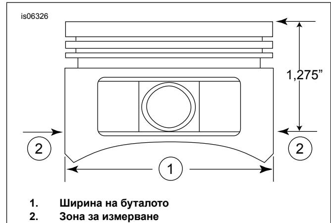
Фигура 2. Мерки на буталото
