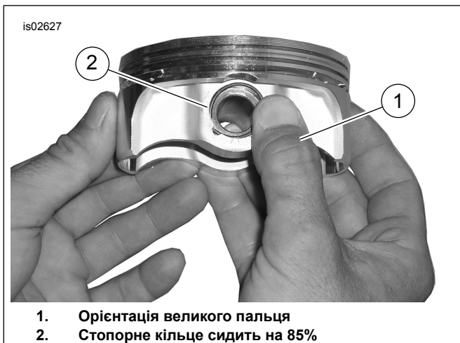
Малюнок 4. Установлення стопорного кільця
