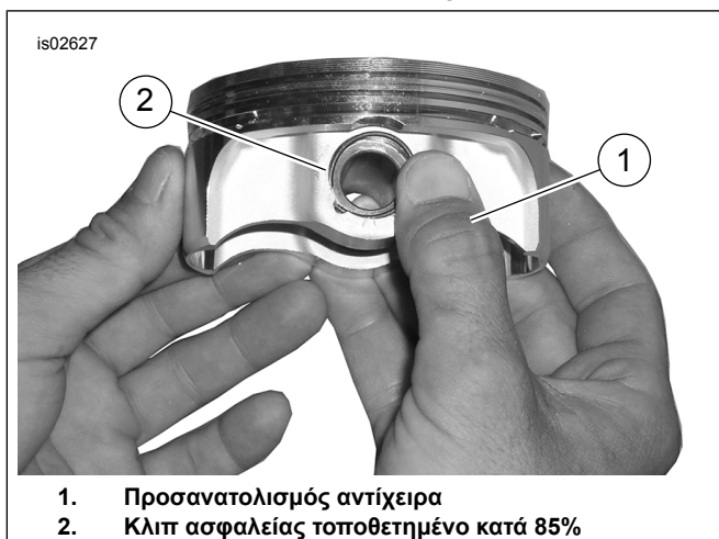
Εικόνα 4. Εγκατάσταση του κλιπ ασφαλείας
