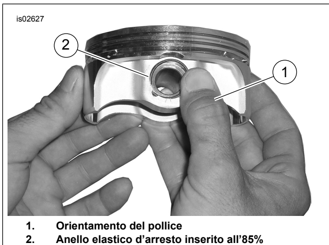
Figura 4. Installazione dell'anello elastico d'arresto
