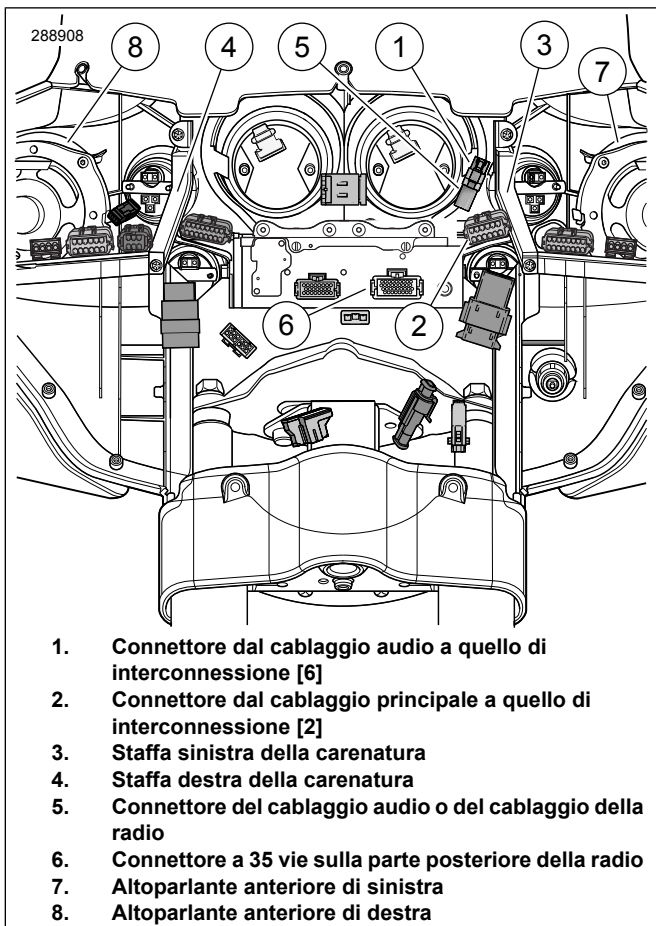
Figura 2. Connettori della carenatura interna (modelli FLHX, FLHT/C/U)
