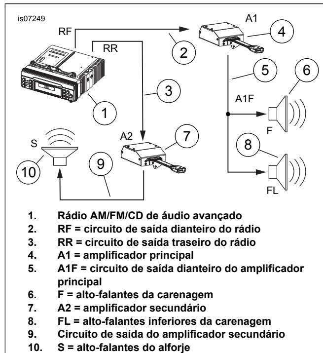
Figura 1. Diagrama do sistema do kit de expansão do alto-falante CVO
