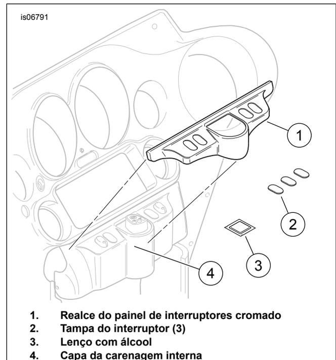
Figura 1. Instalação do realce do painel de interruptores
