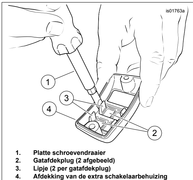
Afbeelding 4. Verwijderen en installeren van de gatafdekpluggen
