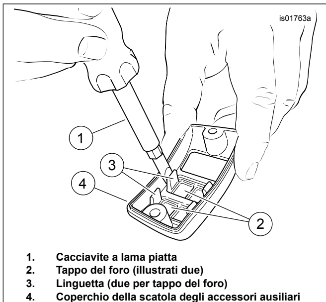
Figura 4. Rimozione ed installazione dei tappi dei fori
