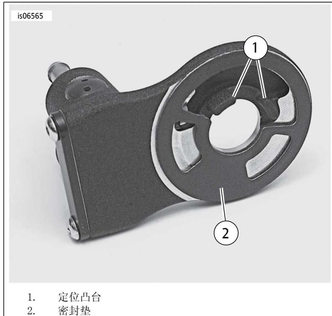
图1。机油冷却器适配器
