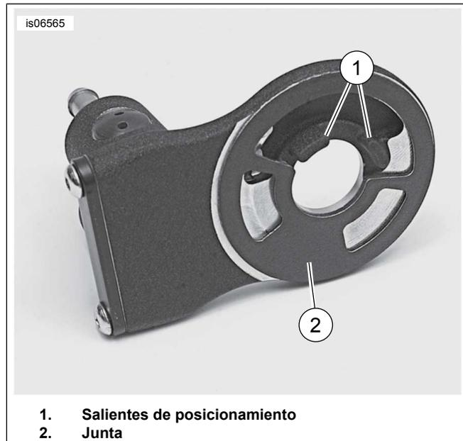
Figura 1. Adaptador del enfriador de aceite
