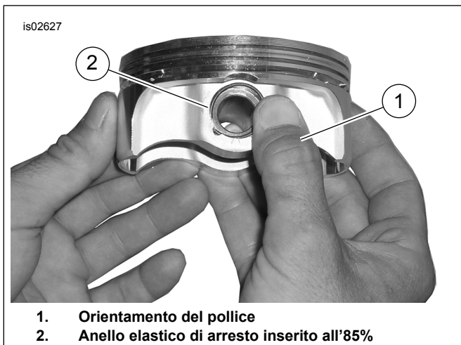
Figura 4. Installazione dell'anello elastico d'arresto
