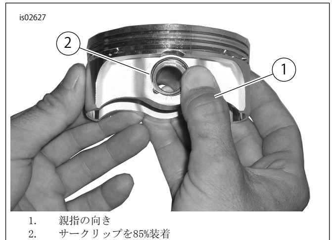
図4。サークリップの取り付け
