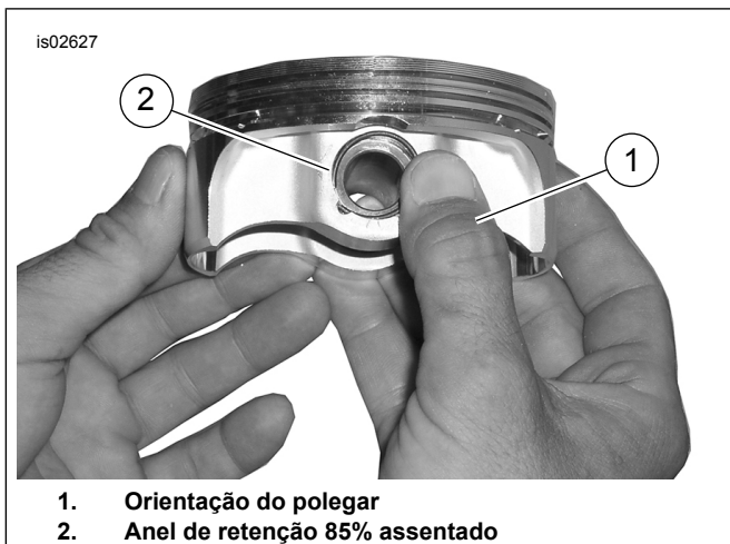
Figura 4. Instalação do anel de retenção
