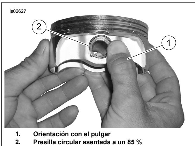
Figura 4. Instalación de la presilla circular
