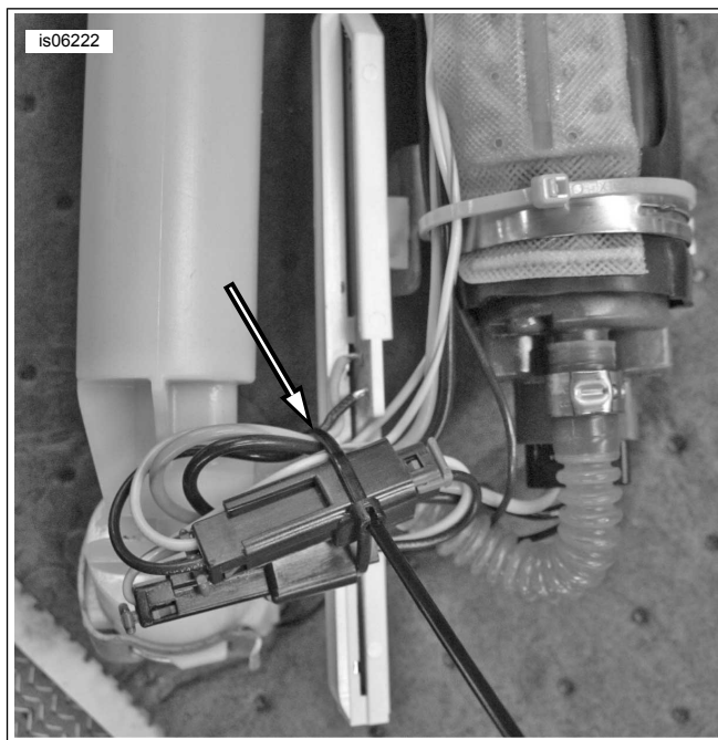
Figur 2. Fastgør brændstofpumpens ledninger og stik
