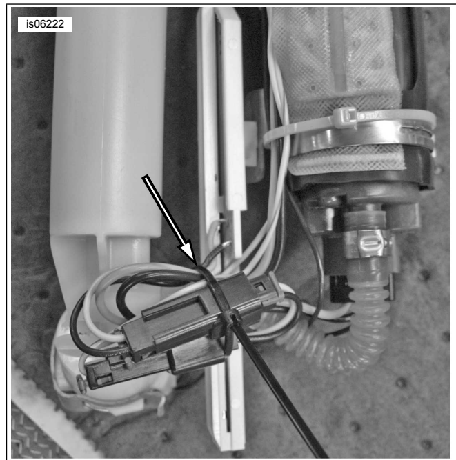
Afbeelding 2. Bevestig de brandstofpompdraden en connectoren
