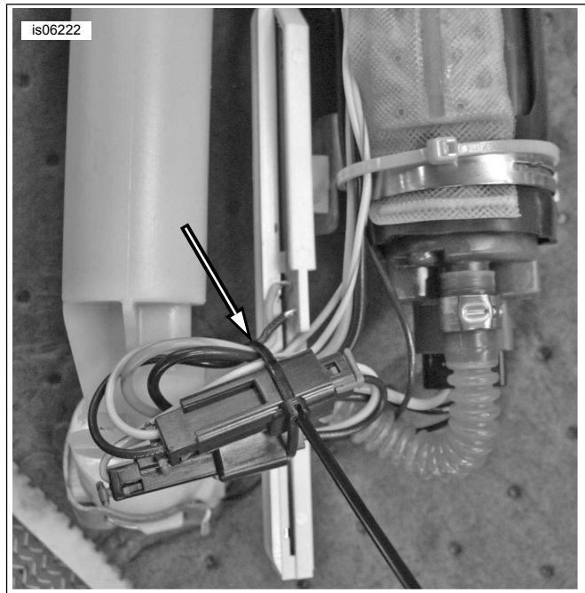
Kuva 2. Kiinnitä polttoainepumpun johdot ja liittimet huolellisesti
