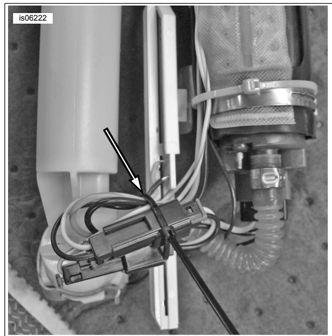
Figure 2. Fixer les connecteurs et les fils de la pompe à carburant
