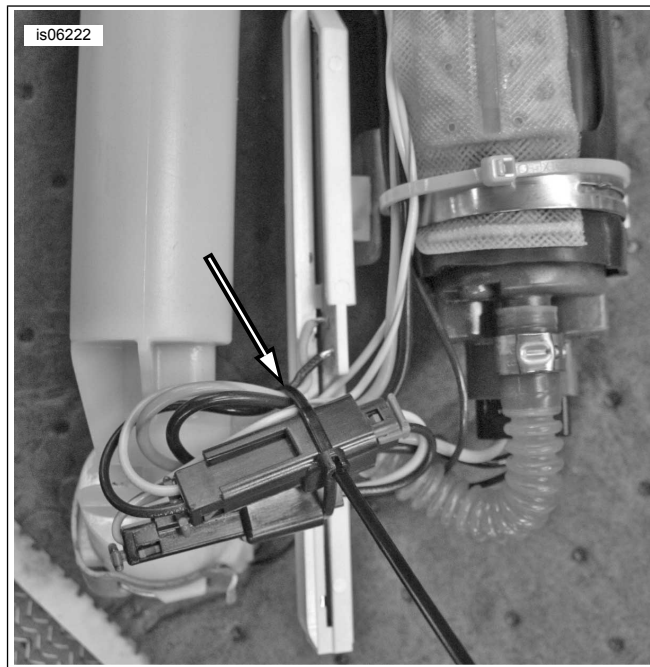
Ábra 2. Az üzemanyag-szivattyú vezetékeinek és csatlakozóinak rögzítése
