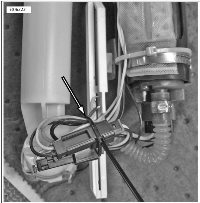
图2. 固定燃油泵导线和连接器
