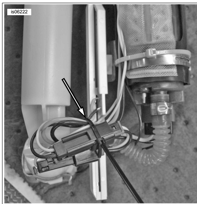
Figura 2. Fili e connettori sicuri della pompa del carburante
