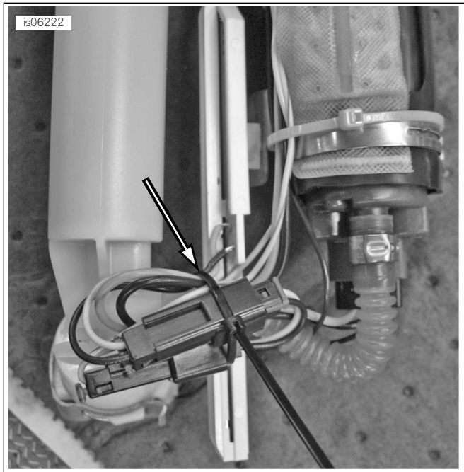
圖2。固定燃油泵電線和接頭
