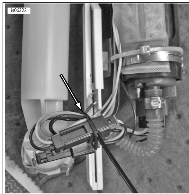
図2。フューエルポンプ配線とコネクタの固定
