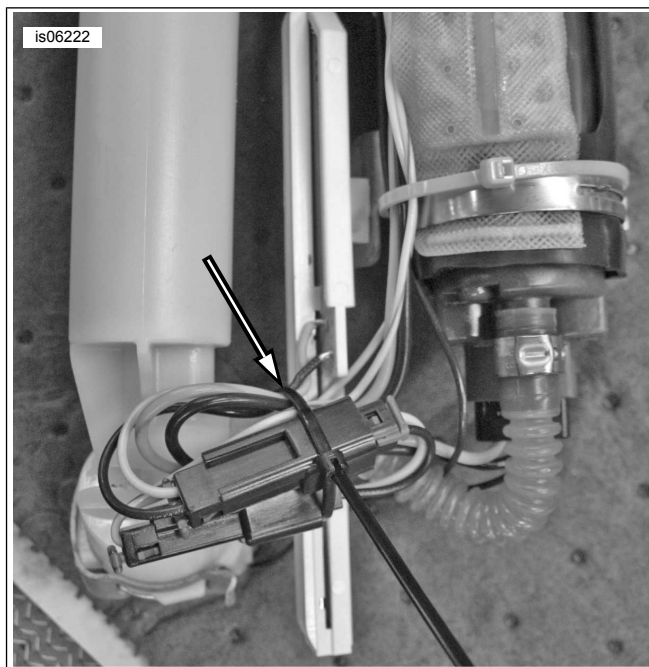
Ilustrace 2. Připevněte kabeláž palivového čerpadla a konektory
