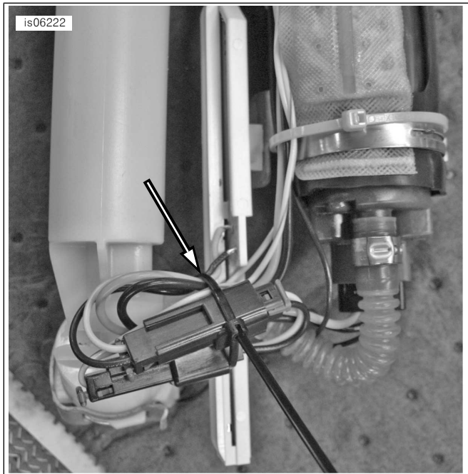
그림 2. 연료 펌프 배선 및 커넥터 고정
