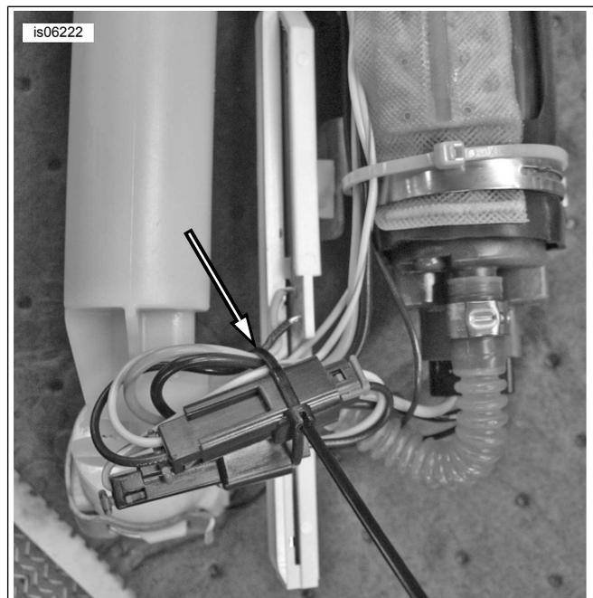
**Figura 2. Fixar os Fios e os Elementos de Ligação da Bomba de Combustível**
