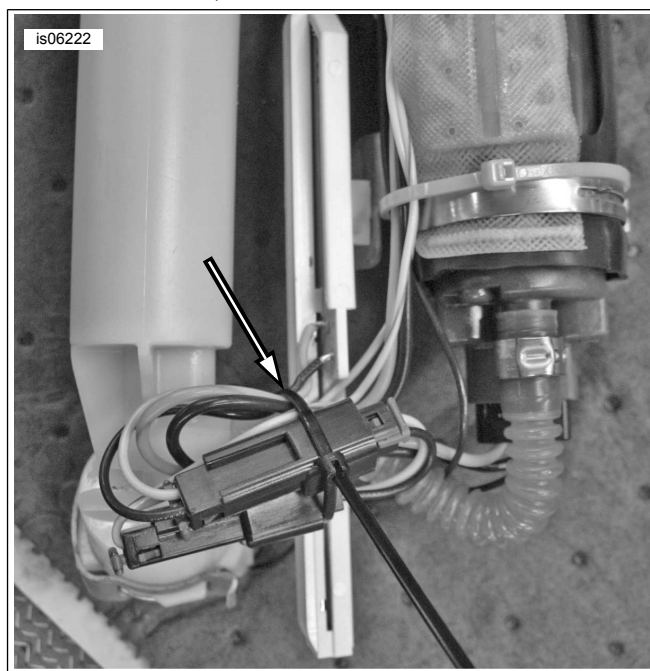
Figura 2. Asigurați firele și conectorii pompei de combustibil
