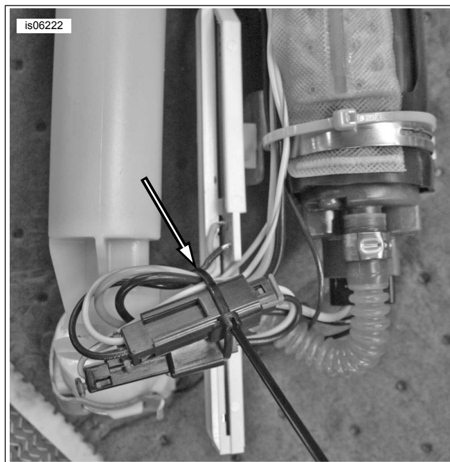
Рисунок 2. Фиксация проводов топливного насоса и разъемов
