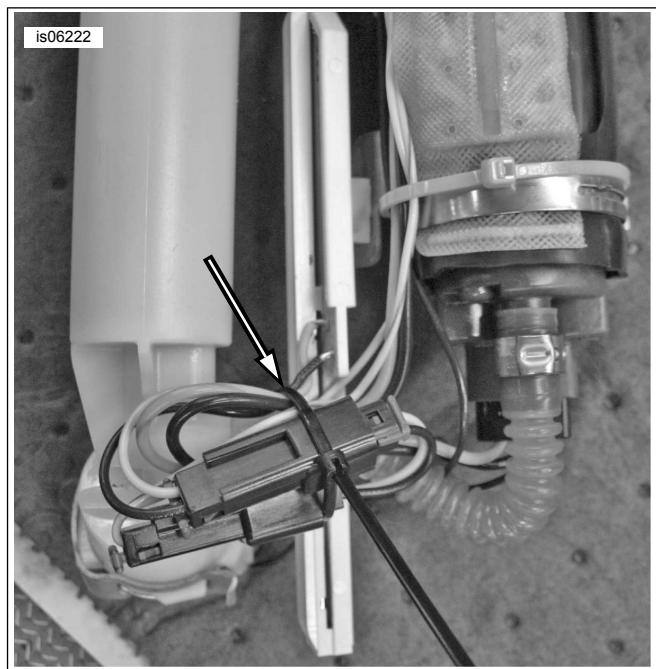
Figur 2. Säkra bränslepumpens ledningar och kontakter
