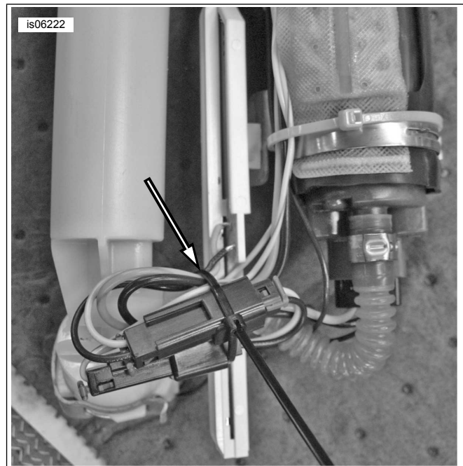
Figure 2. Ikabit nang Maigi ang mga Kable at mga Konektor ng Fuel Pump.
