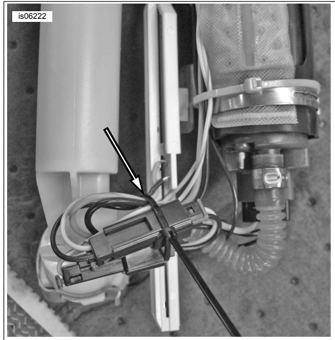
Şekil 2. Yakıt Pompası Kablolarının ve Konnektörlerin Sabitlenmesi
