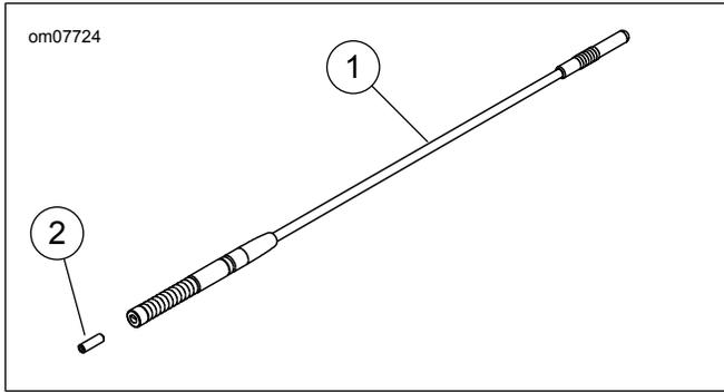
Afbeelding 3. Peças de reposição: Mastro da antena CB curto
