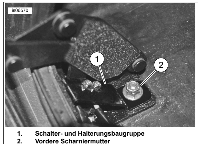
Abbildung 1. Schalter für Aufbewahrungskofferbeleuchtung einbauen
