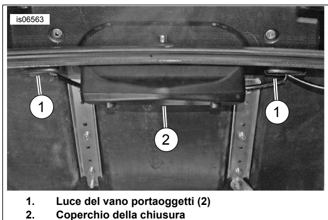
Figura 2. Punti di montaggio della luce del vano portaoggetti (illustrati i modelli 2011 ed anni successivi, simili ai modelli 2009-2010)
