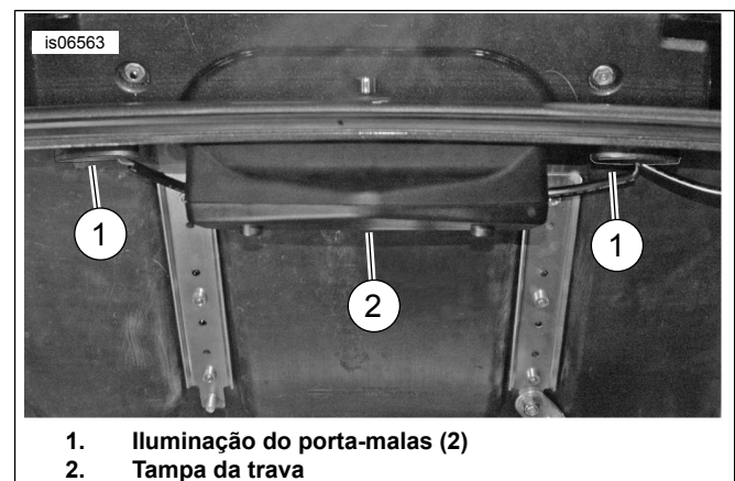
Figura 2. Locais de montagem da iluminação do porta-malas (mostrado modelo ano 2011 e posteriores, similar aos modelos 2009 e 2010)
