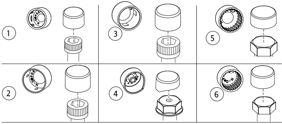
图2。经典样式盖与相应的紧固件
