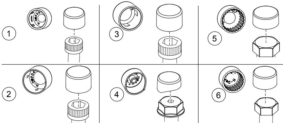
Figure 2. Couvres classiques et attaches correspondantes
