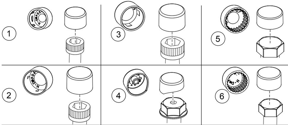
Figura 2. Cubiertas Classic y sujetadores correspondientes
