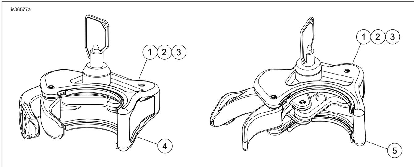
Figure 2. Brides de fixation de pare-brise à déblocage rapide
