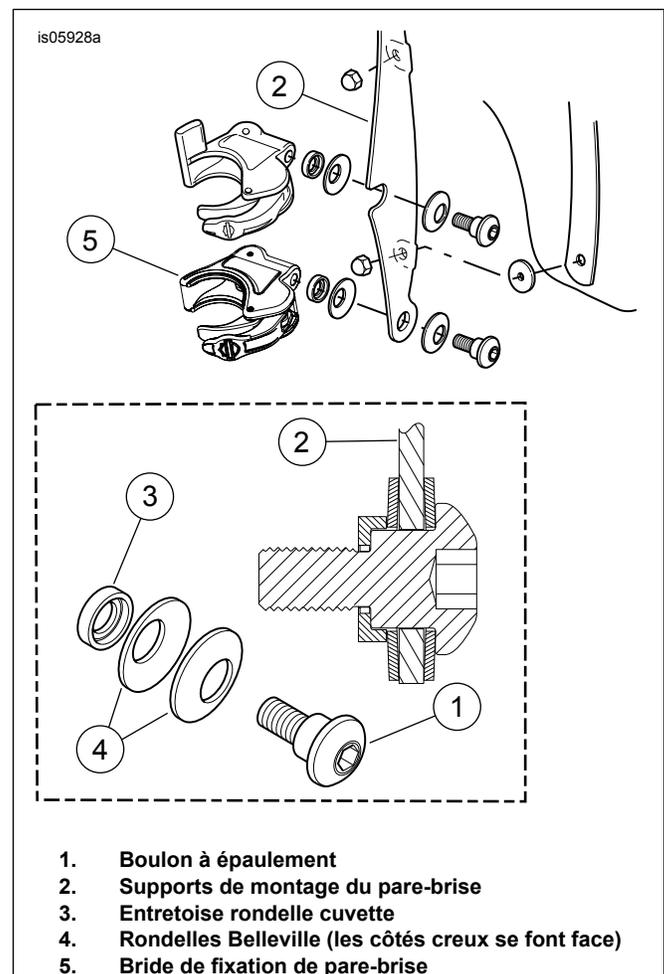
Figure 1. Bride de montage du pare-brise
